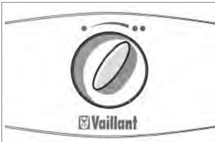
Рис. 3.1 Переключатель мощности
