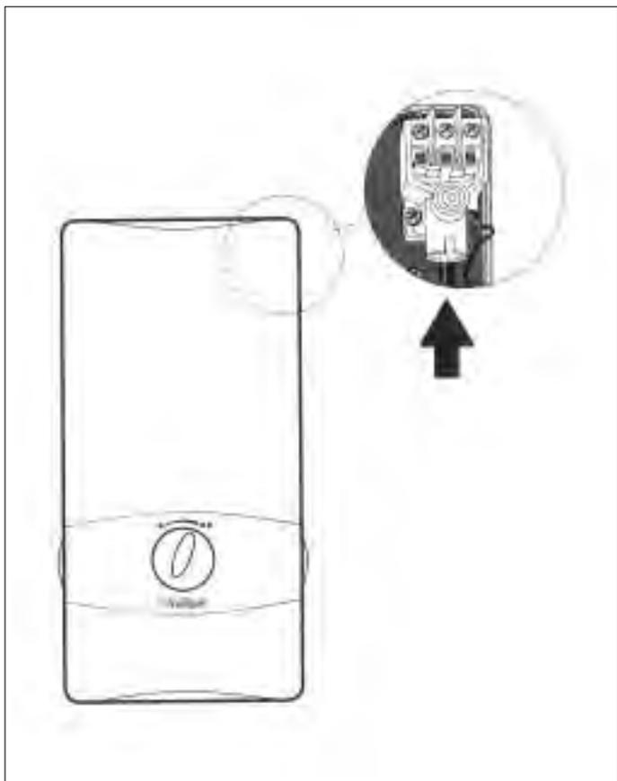
Рис. 5.1 Аварийный выключатель
